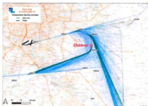
Figure 1 : Résumé - Trajectoires d'une journée en situation de statu quo et de projet en configuration ouest à Paris-Orly
