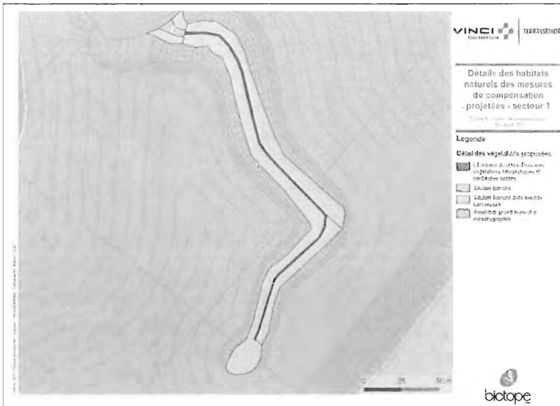
Les actions de réhabilitation consistent à reprofiler le secteur après remblaiement du cours d'eau en conservant le tracé en plan.
